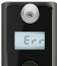
Poskytnutý vzorek vzduchu je příliš malý. Provedte měření znova se silným a rovnoměrným výdechem.
