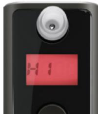
Výsledek měření překračuje měřicí rozsah přístroje.
